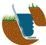
**Lame standard** On recourra à une lame standard pour une utilisation classique avec une bordure libre. Cette lame est disponible en plusieurs hauteurs de travail. La lame dispose d'une aile qui repousse immédiatement la motte sur le côté. On remarquera que le couteau présente une zone de coupe horizontale. Celle-ci permet d'obtenir une bordure parfaitement lisse, tant horizontalement que verticalement.
