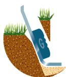
**Lame golf bunker** Cette lame permet d'entretenir les bords de pelouse très hauts, comme ceux des bunkers sur les parcours de golf. Le guidon peut également être incliné sur le côté, afin que l'utilisateur puisse toujours travailler dans une position idéale indépendamment de l'ondulation et de la déclivité du terrain.
