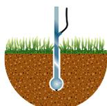
**Lame d'enterrement de câble** Pour délimiter le champ d'action des tondeuses robotisées, il convient d'enfouir un câble. À l'aide d'un couteau spécial et d'un système de débobinage, l'Edge Styler permet d'enfouir un câble électrique de courant continu de manière peu profonde dans le gazon, et ce sans endommager ce dernier.
