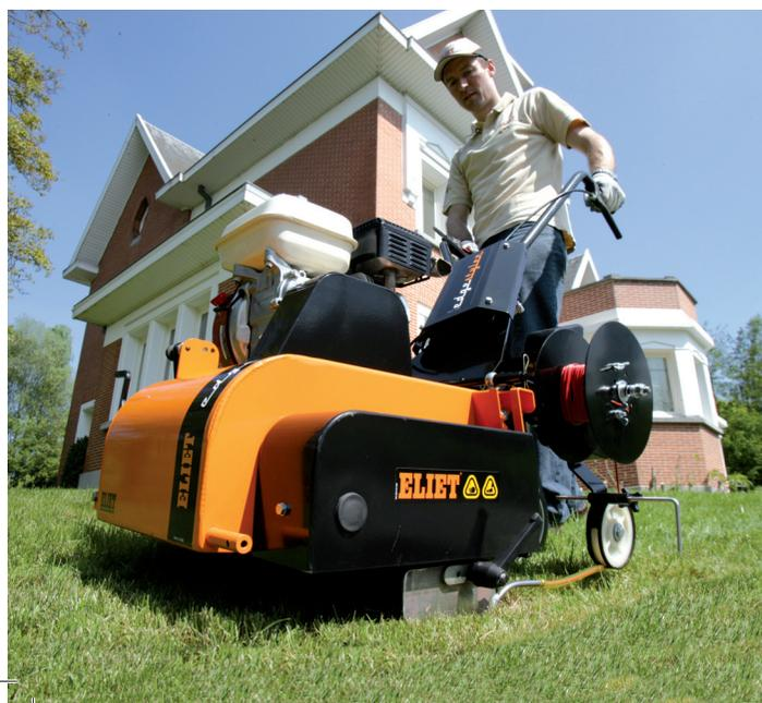
Grâce à un couteau d'enfouissement du câble et à un système de déroulement spécialement conçu à cet effet, l'Edge Styler peut enfouir un câble de courant continu dans la pelouse. En moins de 2 minutes et sans l'aide d'outils, le kit d'enfouissement des câbles peut être installé sur l'Edge Styler PRO. Le système de déroulement est équipé de plusieurs types de câbles et bobines.
