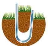
**Lame en U** Si vous désirez installer un système d'irrigation dans le gazon ou y poser une ligne électrique de basse tension, ELIET met à votre disposition une lame en U parfaitement adaptée pour creuser une tranchée temporaire en n'endommageant que légèrement votre gazon. La motte arrachée pouvant être replacée par la suite dans la tranchée, cette intervention est très discrète et toute trace en disparaît en très peu de temps.
